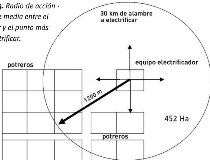
capaces de electrificar. A mayor potencia, mayor radio de acción, mayor área de cobertura y mayor longitud de tendido de alambre dentro del área delimitada. Si se excede el radio recomendado, se perderá voltaje en la línea, por lo que es importante la correcta elección de la potencia del equipo, en base a las dimensiones del sistema que se pretende diagramar.
