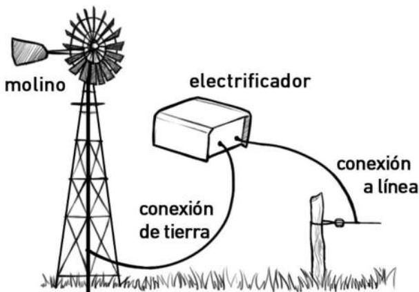
**Figura N°4.** Utilización de la cañería de un molino para lograr una correcta masa para generar un buen rendimiento del sistema.
