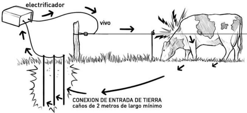
2. Una conexión de salida hacia el alambrado a electrificar.
